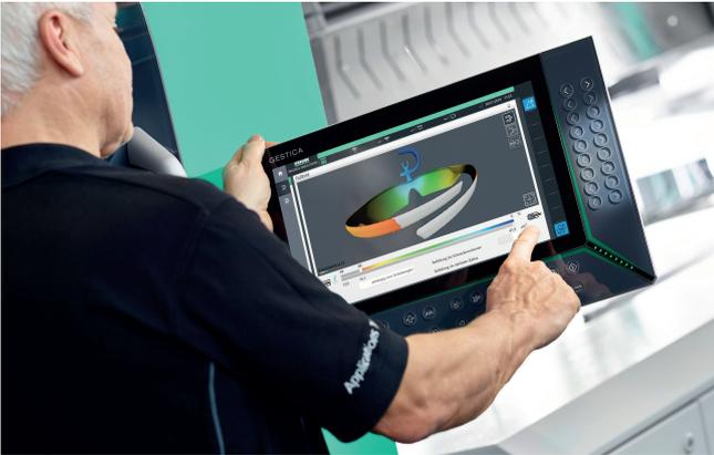
**Bild 5.** Der „aXw Control FillAssist“ zeigt dem Bediener, was gerade im Werkzeug passiert © Arburg
