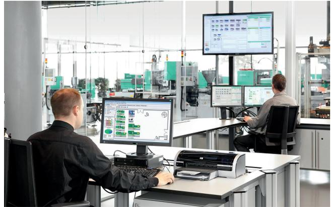
**Bild 6.** Das Leitrechnersystem ALS sorgt für eine durchgängige IT-Netzwerkung © Arburg
